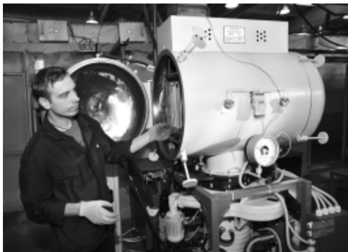
Термист А.Н. Терешкин загружает детали в рабочую зону вакуумной печи «Вега-7».
