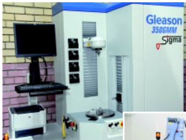
Цех 54: зубоизмерительная машина «SIGMA-3».
