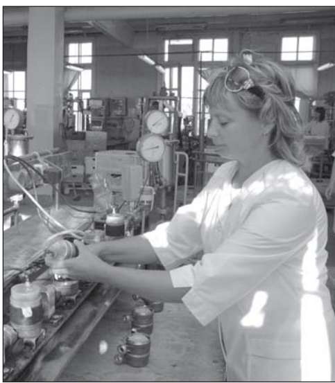
Здесь СВК проверяют на герметичность.
