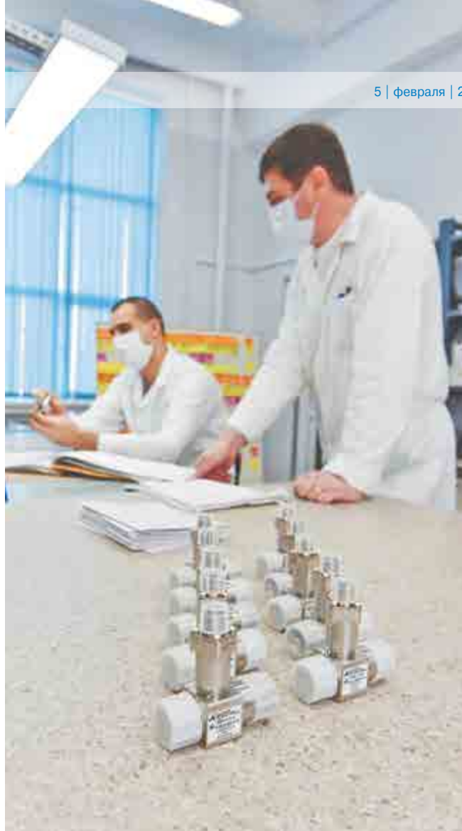
Мастер участка цеха №55 Дмитрий Корчагин и регулировщик РЭАиП Александр Воронин ведут проверку электрических параметров ТПР.
