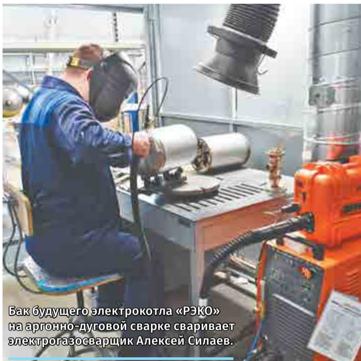
Процесс приваривания нормали к фланцу бака электродкотла.
